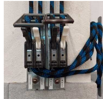
Sicherungsriegel oben = offen, jetzt lässt sich die Höhe verstellen
